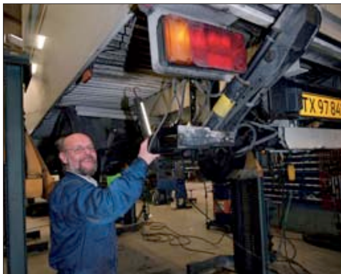
Odense Auto-El er serviceværksted for Zepro. Her er Mogens Henriksen ved at lave service på en bagsmækklift.
